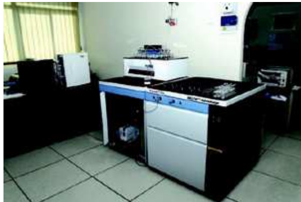
Equipo de espectrometría de masas para la medida de isótopos estables (deuterio, oxígeno-18, carbono-13...).
